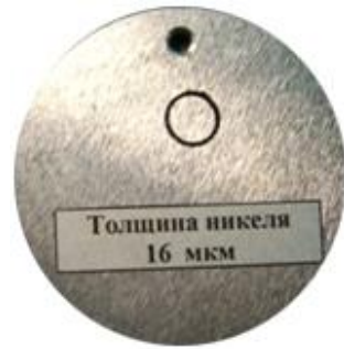
Натурная мера толщины металлического покрытия на образцовом основании (электролитический никель толщиной h_{\text{макс}} = 16 \text{ мкм} )
