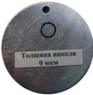
Образцовое основание без покрытия
