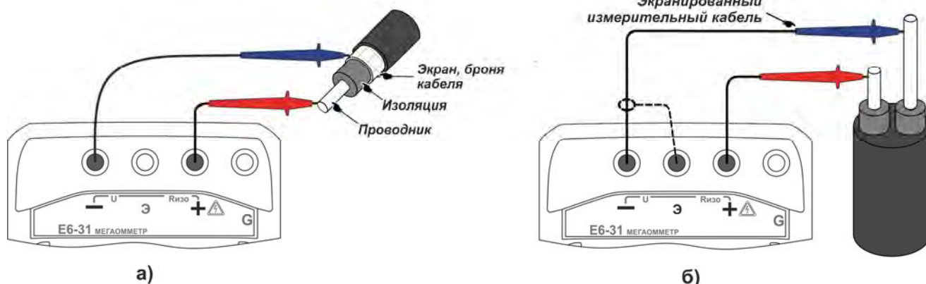
Рисунок 2.11 - Измерение сопротивления изоляции
