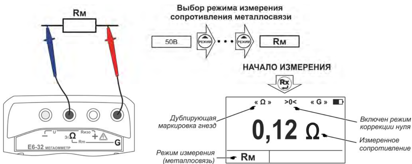
Рисунок 2.8 - Измерение сопротивления металlosвязи
